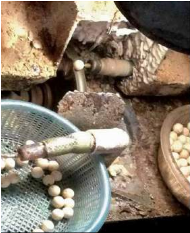
Chiếc máy này khoan một lỗ xuyên qua những hạt gà lớn với dòng nước chảy nhỏ giọt để giảm bụi gà
